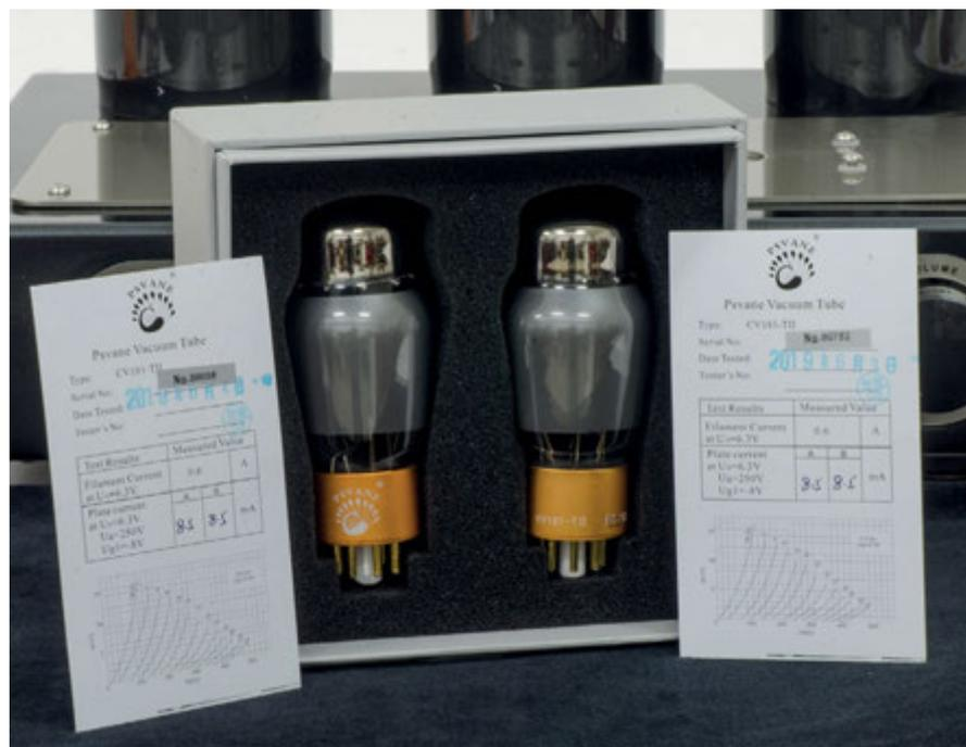
Le valvole adottate in questo progetto sono delle CV181, appartenenti alla famiglia delle 6SN7 (doppio triodo a medio  $\mu$ ), molto apprezzate per le loro prestazioni sonore. CanEVER impiega degli esemplari prodotti da Psvane, selezionati e forniti con tanto di scatola e misure.
