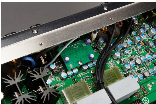
ZeroUno DAC MKII採用ESS9018s DAC晶片，以XMOS自己撰寫韌體，加上重量級電源供應，可說是玩家級作法。DAC晶片藏在圖中小電路板下方。
