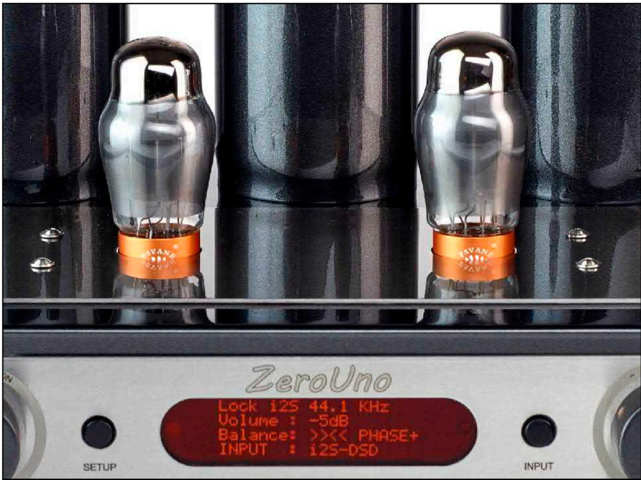
in Classe A privo di feedback negativo globale e viene fornito di serie con le 6SN7 CV181MKII realizzato da Psvane, replica della MULLARD CV181, con rivestimento in grafite all'interno del bulbo di vetro che riduce la microfonicità dei tubi e migliora la dissipazione del calore. Il resto della componentistica è, per così dire, da *boutique*: condensatori Vishay MKP, Mundorf Supreme Silver/Oil e Mundorf Supreme Silver/Gold.
